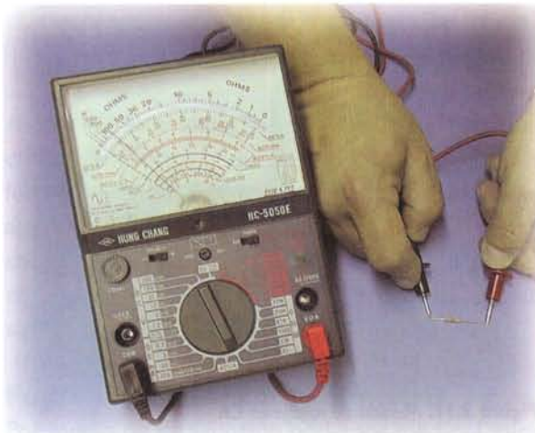
Figura 3.8. Medida de una resistencia de 100\Omega
